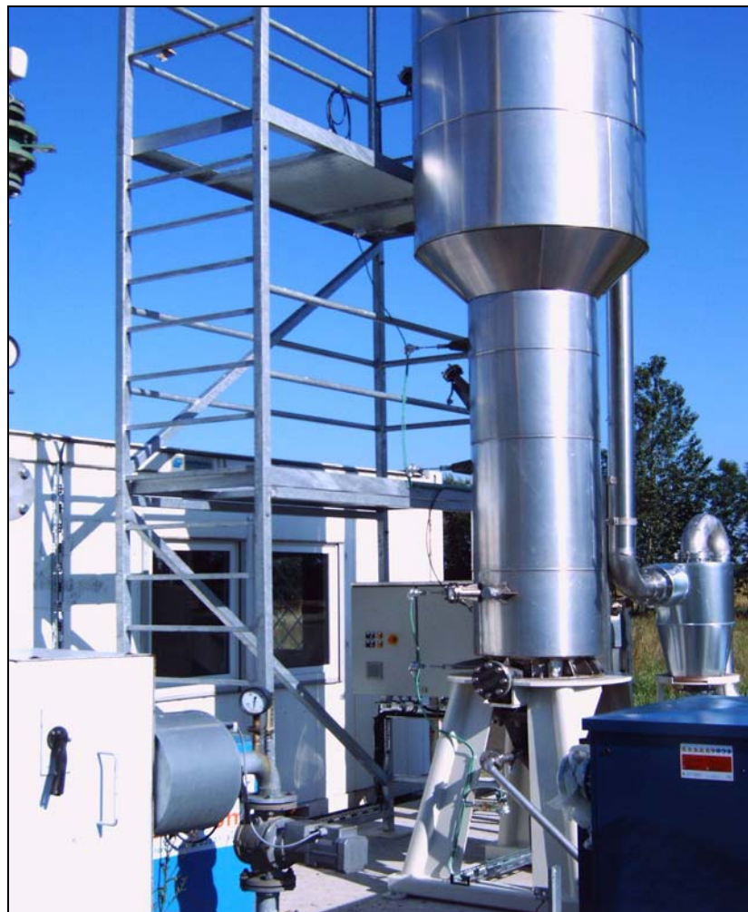
Abb. Wirbelschichtfeuerung- Reaktor mit Abgasleitung u. Zyklon
